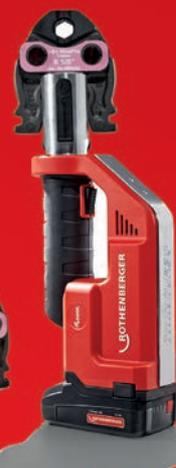
Les systèmes de réfrigération et les pompes à chaleur peuvent être installés rapidement, en toute sécurité et à peu de frais au lieu de raccorder les tuyaux en cuivre par brasage. Et cela sans l'utilisation d'une flamme nue ou d'autres précautions. De plus, la compression en 3 points sur le raccord assure une connexion sûre et étanche en permanence au tuyau utilisé.
